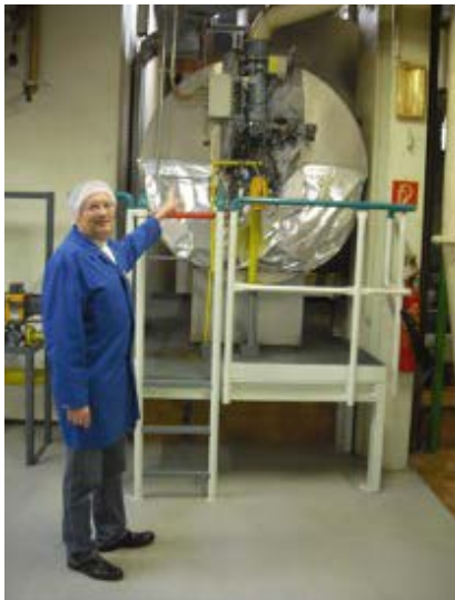
Helmut Plath vor dem Stützbrenner des Rösters RFB4. Er sorgt dafür, dass der Katalysator der Röstmaschine auf Betriebstemperatur kommt.
